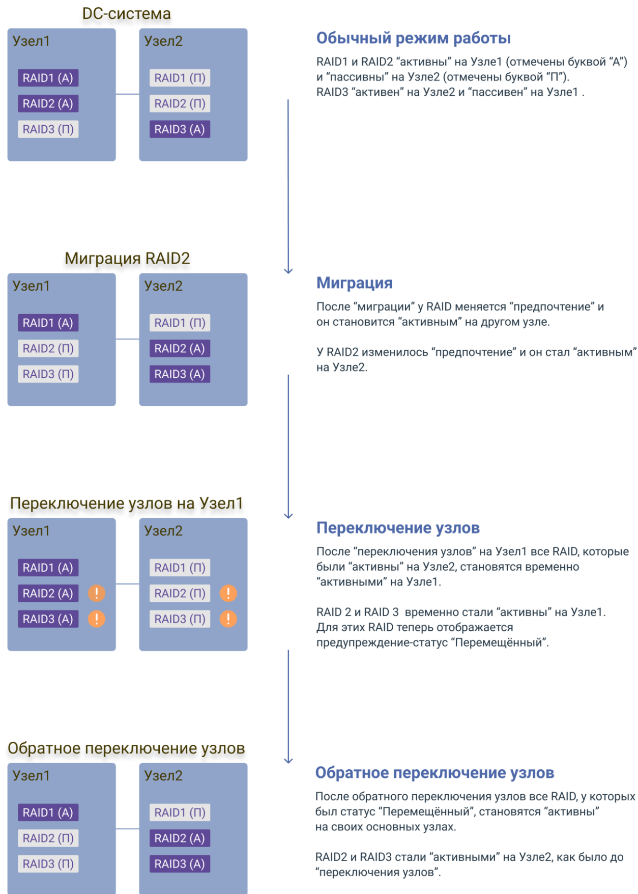
Рисунок 81. Пример работы «миграции» RAID и «переключения узлов»
